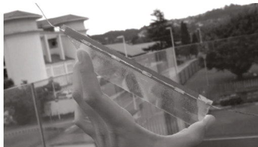
Figura 19: Demostración del recubrimiento reflectante IR transparente sobre vidrio. Grosor total de la película delgada del orden de 60 nm. Fuente: Autores.
