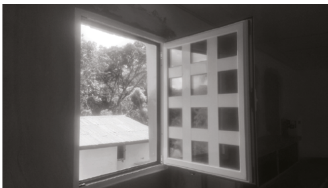
Figura 21. Prototipo de experimentación para recibir cristales fotovoltaicos en medidas de laboratorio. Fuente: Autores.
