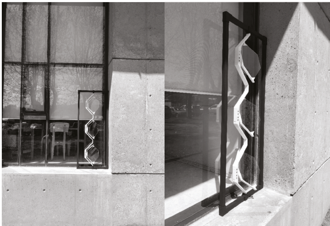
Figura 13. Impresión 3D del sistema compuesto, con mecanismo funcional ensamblado. Fuente: Autores.
