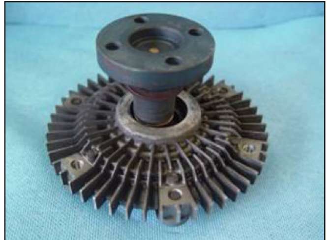
Rodamiento del Fan Clutch bloqueado – rotura
