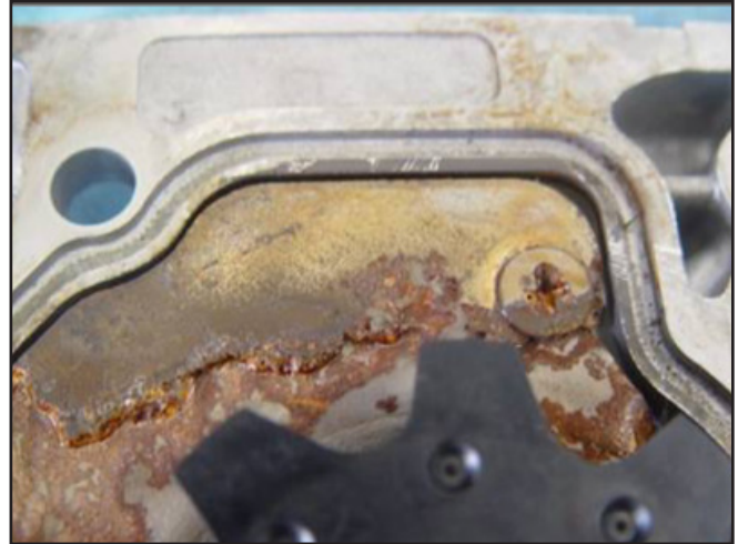
Corrosión de Placa Inferior
