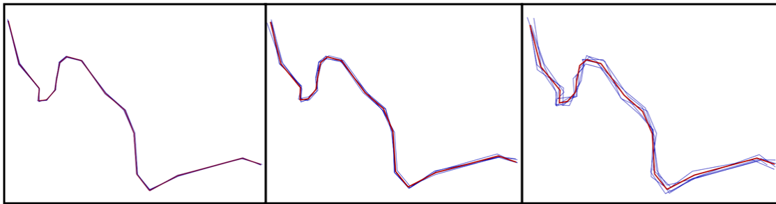
FIGURE 4.4 – Effet du paramétrage de la fonction gaussienne sur le bruitage des sommets d'une polyligne
