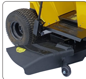
Ruedas copadora de desniveles de terreno para evitar golpes en la plataforma y en las cuchillas.
